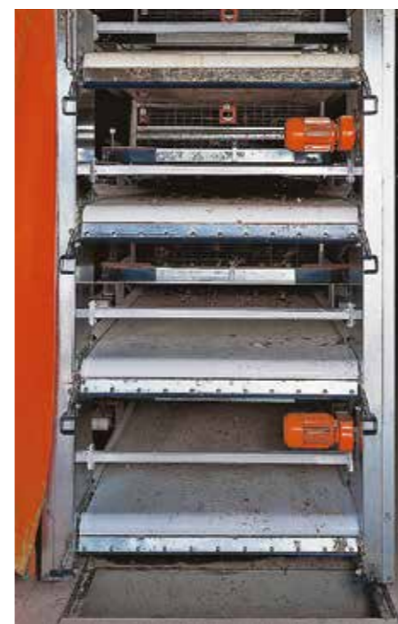
Remoção de esterco no final do conjunto com janela para esterco.
