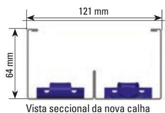
Vista seccional da nova calha
