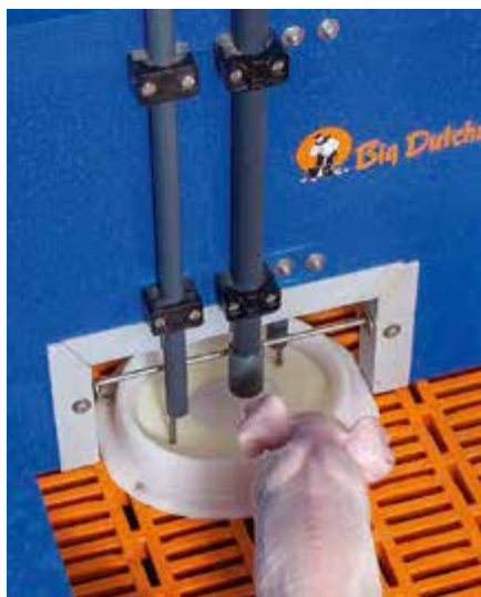
Um sensor verifica o nível de alimentação no cocho e informa ao computador 510 pro
