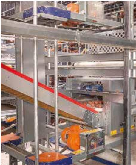
Coleta de ovos com esteira vertical e sistema automático de coleta de ovos por meio de elevador
