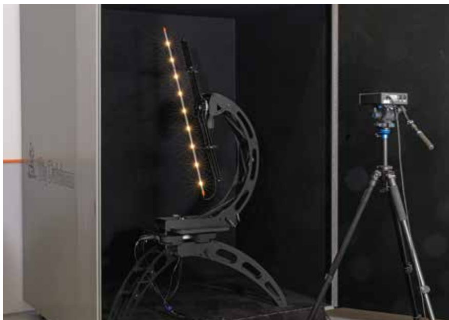
Goniômetro - testando nossa lâmpada FlexLED
