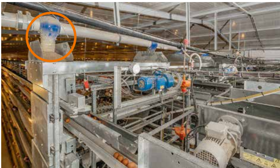
Conjunto frontal com acionamento e enchimento de ração
