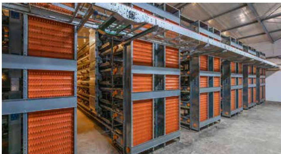
Exemplo de um aviário UV 600 de seis andares com carro de ração automático
