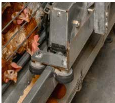
Rodas de borracha com rolamentos de esferas garantem funcionamento silencioso e suave do carro de ração
