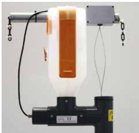
**EASYSLIDER** é um dispositivo de dosagem controlado por computador para baias de maternidade. A matriz pode escolher por si mesma quando e quanto quer comer. Basta apenas acionar um pêndulo dentro do tubo de alimentação, que libera uma porção de ração.
