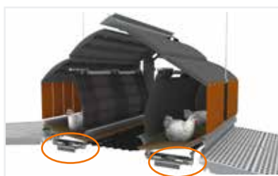
A NESCA é composta por piso de arame inferior apoiada em quatro células de carga, que transmitem os resultados ao controlador de produção por meio de um módulo de pesagem
