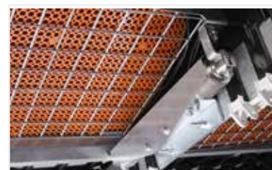
A NESCA é composta por piso de arame inferior apoiada em quatro células de carga, que transmitem os resultados ao controlador de produção por meio de um módulo de pesagem
