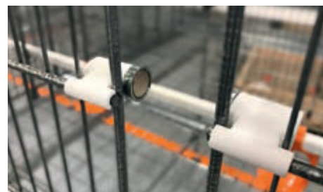
Trava magnética na parte frontal da gaiola para fechamento seguro
