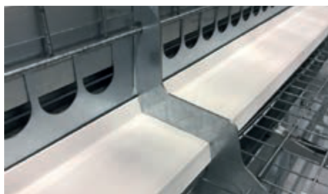
Vista das janelas de alimentação no andar inferior e da pista de plástico
