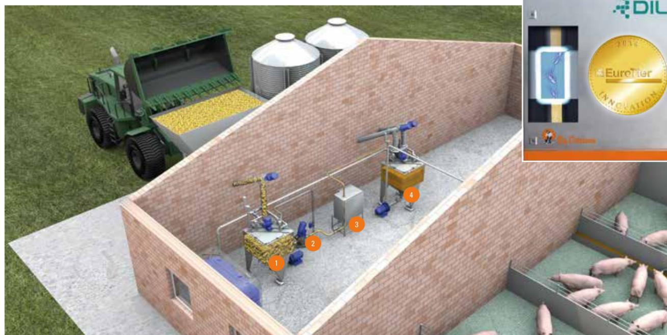
PEF significa Pulsos Elétricos de Alta Tensão (*Pulsed Electric Fields*). Esses pulsos de alta tensão são aplicados ao milho cortado (espiga/cana/palha), abrindo assim as células e tornando a planta inteira digerível para suínos em terminação.
