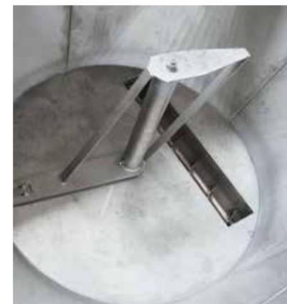
O seu fundo circular está equipado com uma lâmina em forma de Z que é alimentada por um motor de engrenagem. Esta lâmina efetivamente evita "ocos" dentro do sistema.
